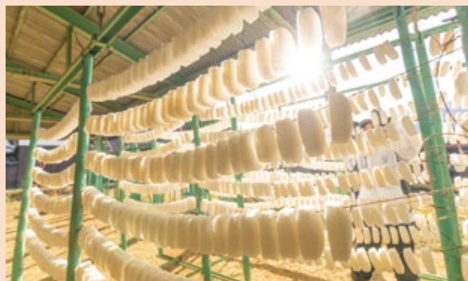
「つやの玉」の乾燥風景。カビの発生や腐敗が最小限に抑えられる11月～3月に、自然の恩恵を最大限に利用して製造する。計18工程に及ぶ作業の約80%は屋外で行う
